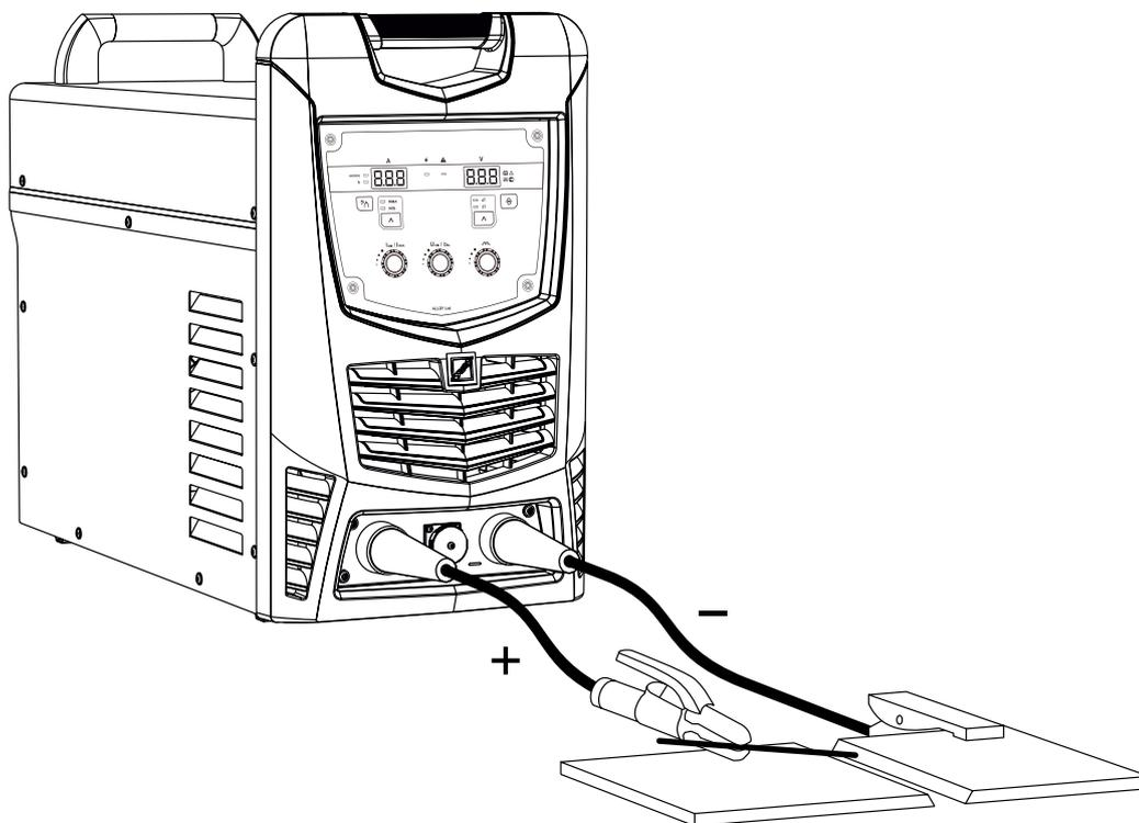
Рис. 5.5 Схема подключения аппарата в режиме ММА
