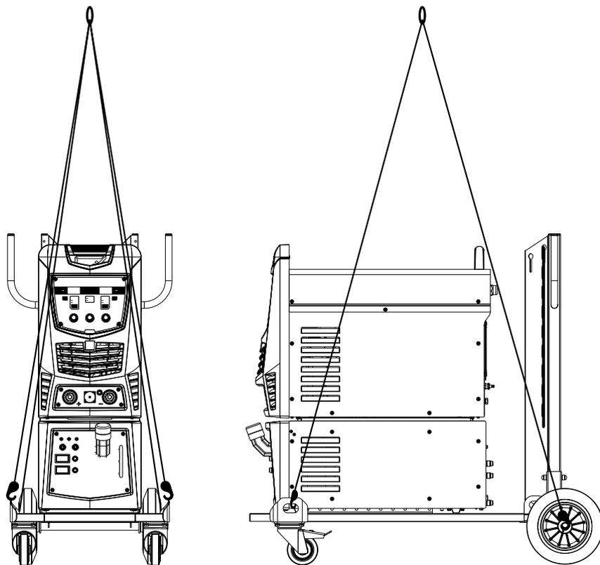
Рис. 9.1 Схема строповки.
