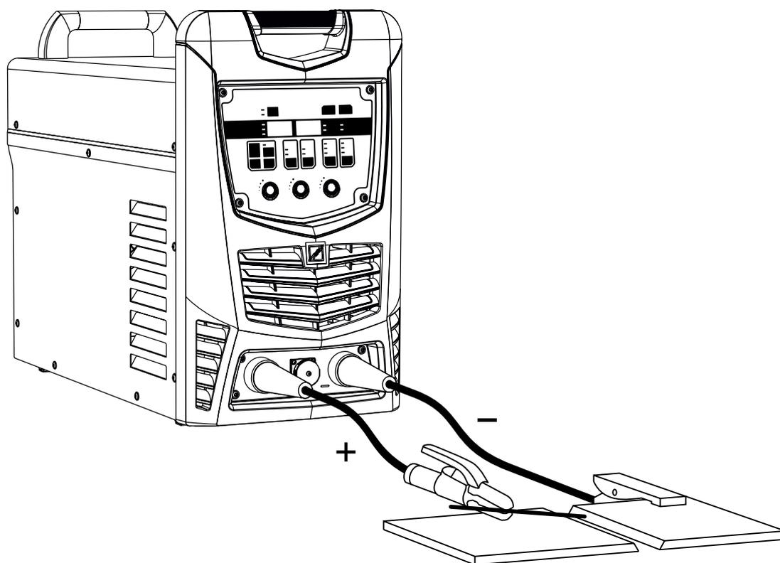
Рис. 5.4 Схема подключения аппарата в режиме ММА
