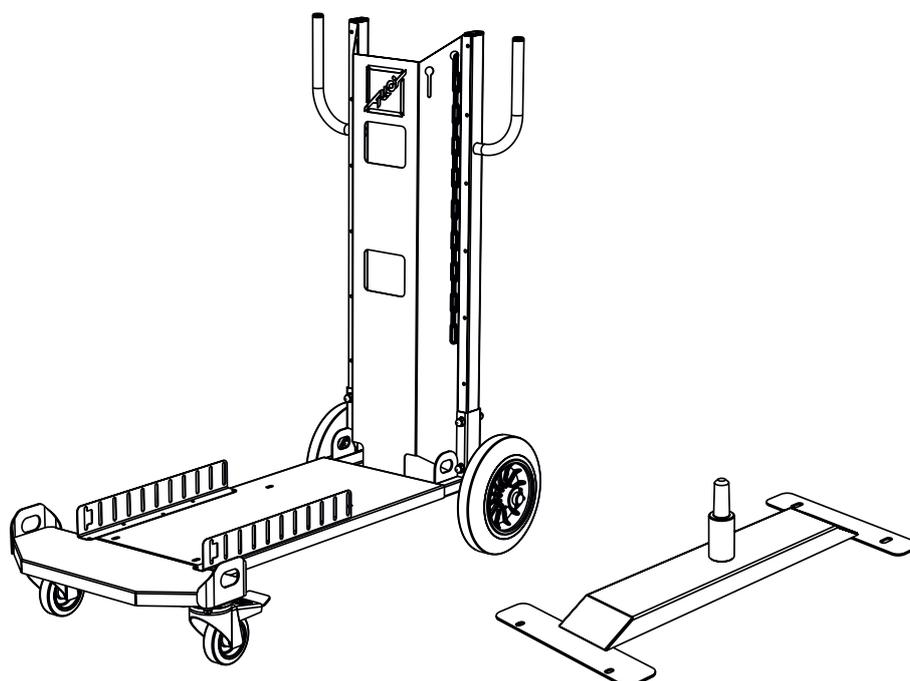
Рис. 3.5 Внешний вид транспортной тележки и турели
