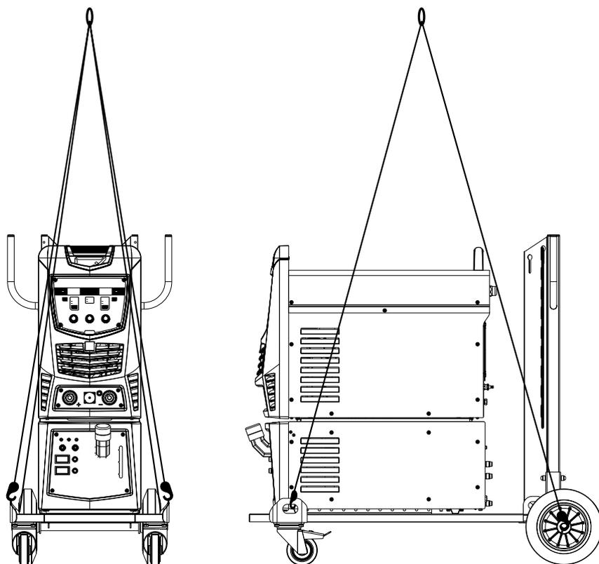
Рис. 9.1 Схема строповки.
